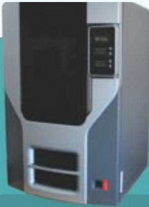
ABS 樹脂を造形ヘッドで熱溶解し、X 軸・Y 軸方向の高速動作制御と造形テーブルの Z 軸昇降(積層ピッチ 0.254mm / 0.330mm)により、モデルの精密な積層造形を可能にしています(熱溶解積層方式)。
