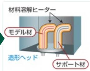
2 造形ヘッド内の材料溶解ヒーターにて溶かされる
