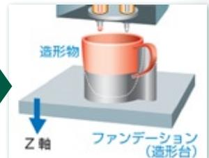
4 造形台がZ軸方向に移動しながら積層され造形される
