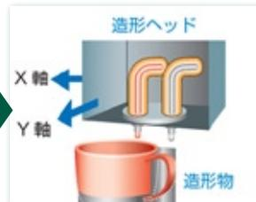
3 造形ヘッドがX軸Y軸方向に動きながら材料を射出
