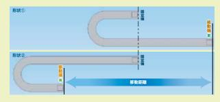
これを解決するには、各メーカのカタログで指示しているリンク数、ピッチ、最小曲R、末端長と移動端の移動距離前後値を入力します。これにより簡単にケーブルベア長さを維持し、折返し点距離も自動計算されます。さらに移動端の切替えができ、フィーチャを追加削除することなく容易に形状変更や拘束条件維持が可能です。
